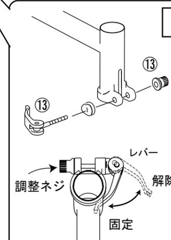
調整ネジを一定の硬さまで締めて、レバーを固定の方向へ倒してください。レバーが固い時は調整ネジを回してレバーの調整をしてください。
