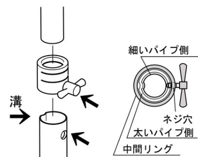
※パイプのネジ穴と中間リングのネジの位置を合わせてください。中間リングのネジは締め付けすぎないようにご注意ください。ネジを締め過ぎると破損してしまう恐れがあります。
