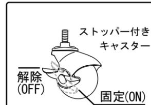
キャスター2個にはストッパーが付いております。移動の際は必ずキャスターのストッパーを解除 (OFF) してから移動してください。また、固定する際はストッパーを (ON) 側に倒しますとキャスターが固定されます。
