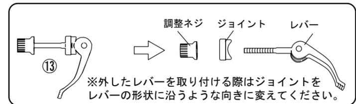
※外したレバーを取り付ける際はジョイントをレバーの形状に沿うような向きに変えてください。
