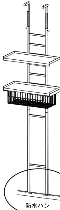
脚の設置場所を確認してください。どうしても平面に脚の設置場所がとれない場合は下図のように防水パンの縁をご利用ください。その場合は手順1は不要です手順2から組み立ててください。
